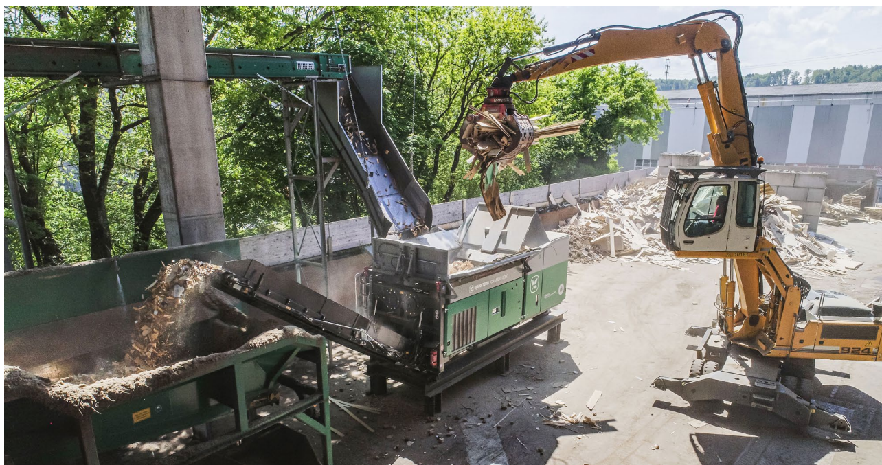
Après le broyage, le criblage et la séparation des métaux, le combustible convient de manière optimale à une utilisation dans les centrales à biomasse. Si des problèmes surviennent avec les machines, la maison GETAG, partenaire de distribution de Komptech pour la Suisse, intervient toujours immédiatement.
